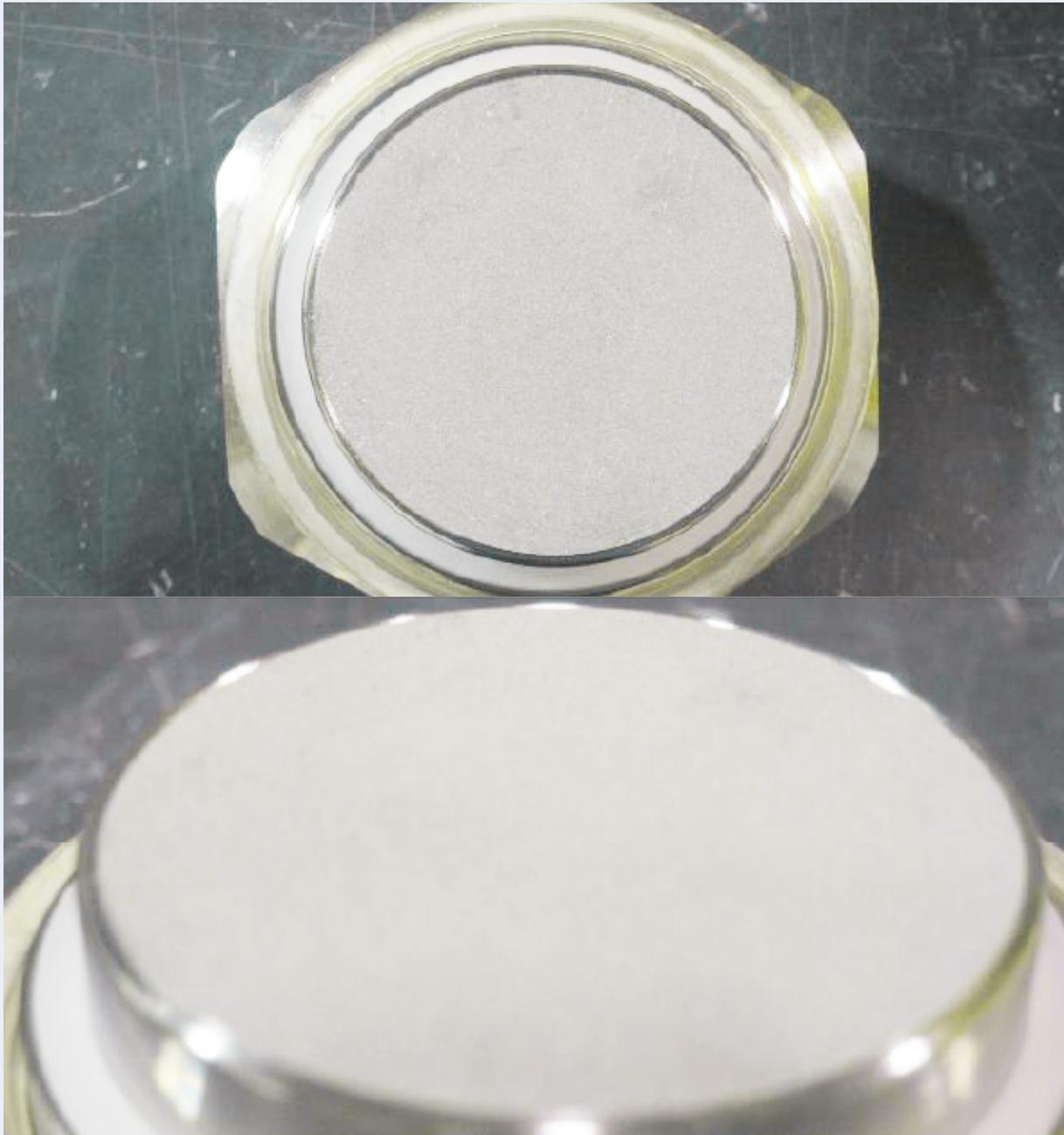
Abb. 5: Geöffnete Säule mit Einlassfritte nach 1.000 Injektionen
